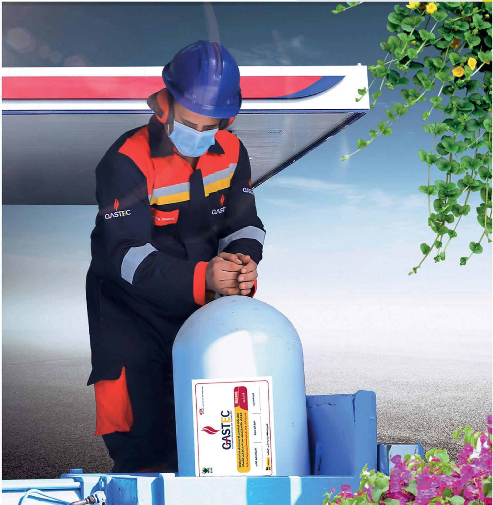
بعد اختبار الأسطوانات أحد أهم مكونات عملية تحويل السيارات للعمل بالغاز الطبيعي لضمان سلامة مكونات طقم التحويل وبالتالي سلامة المركبات والمواطنين، لذلك تقدم شركة غازتك خدمة اختبار الأسطوانات لكافة عملاء الغاز الطبيعي للسيارات في مصر من خلال مراكز الاختبار التابعة للشركة على النحو التالي:
